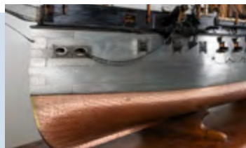
Coque en bois recouverte de métal
