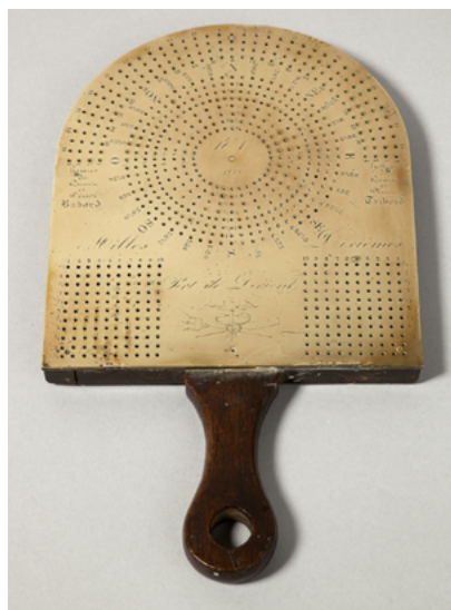
Renard de navigation en cuivre, 1ère moitié du 19e s., 3 NA 1 © musée national de la Marine/ A. Fux
