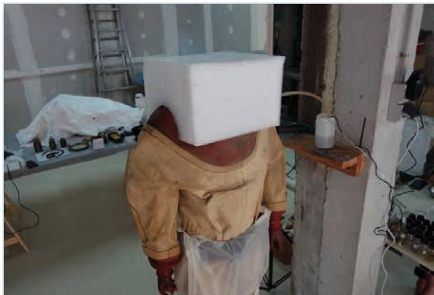
Mise en place d'une enceinte de micronébulisation, destinée à redonner de la souplesse au col en caoutchouc du scaphandre Denayrouze. Procédé expérimental © Groupement Rouge Cadmium
